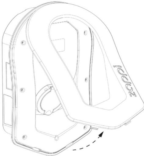
Entfernen Sie vorsichtig die Abdeckung der zappi indem Sie die beiden Clips an der Unterseite des Geräts nach innen drücken, während Sie die Abdeckung zu sich ziehen.
