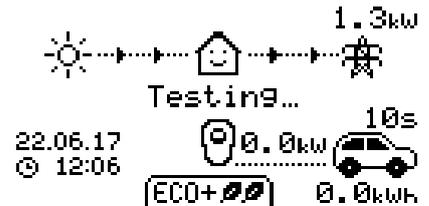
4. Der Boost wird zum spätestmöglichen Zeitpunkt gestartet, um die eingestellte Energiemenge zu erreichen. Wenn der aktuelle Ladevorgang bereits genügend Energie gespeichert hat, wird der Boost nicht benötigt und ist daher nicht aktiv.
