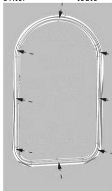
12. Remontez l'unité frontale en connectant correctement le câble plat avec multiprise en façade ainsi que sur le PCB principal. Utilisez à nouveau le tournevis dynamométrique et serrez les 8 vis de la façade à un maximum de 1,2 Nm.
