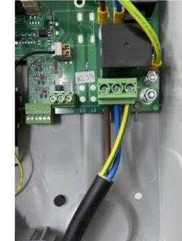
10. Connectez toutes les connexions pertinentes CT dans les fiches CT fournies. Insérez correctement les fiches dans le bloc de connexion CT. Notez ce que chaque connexion CT mesure, par exemple le secteur, la production, la batterie domestique AC. Utilisez le fil rouge comme + et le fil noir comme -. Vous pouvez également utiliser un Harvi si vous ne parvenez pas à câbler les bornes CT dans le zappi.
