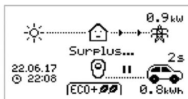
Un surplus/excédent suffisant est disponible et zappi est sur le point de charger le VE. Une minuterie est décrétementée et peut être réglée dans les paramètres de charge (uniquement en mode ECO+).
