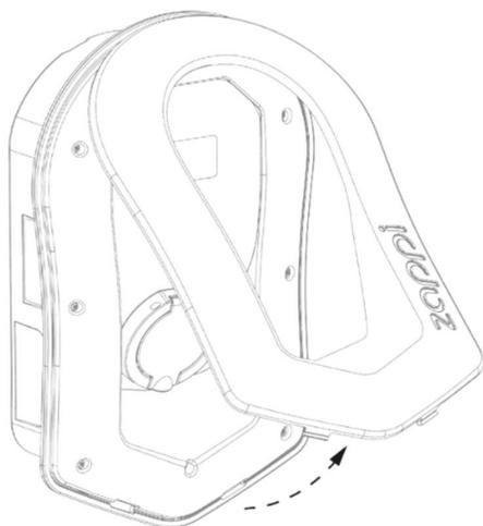
Retirez délicatement la façade du zappi en appuyant sur les 2 clips situés en bas de l'appareil vers l'intérieur tout en tirant la façade vers vous.
